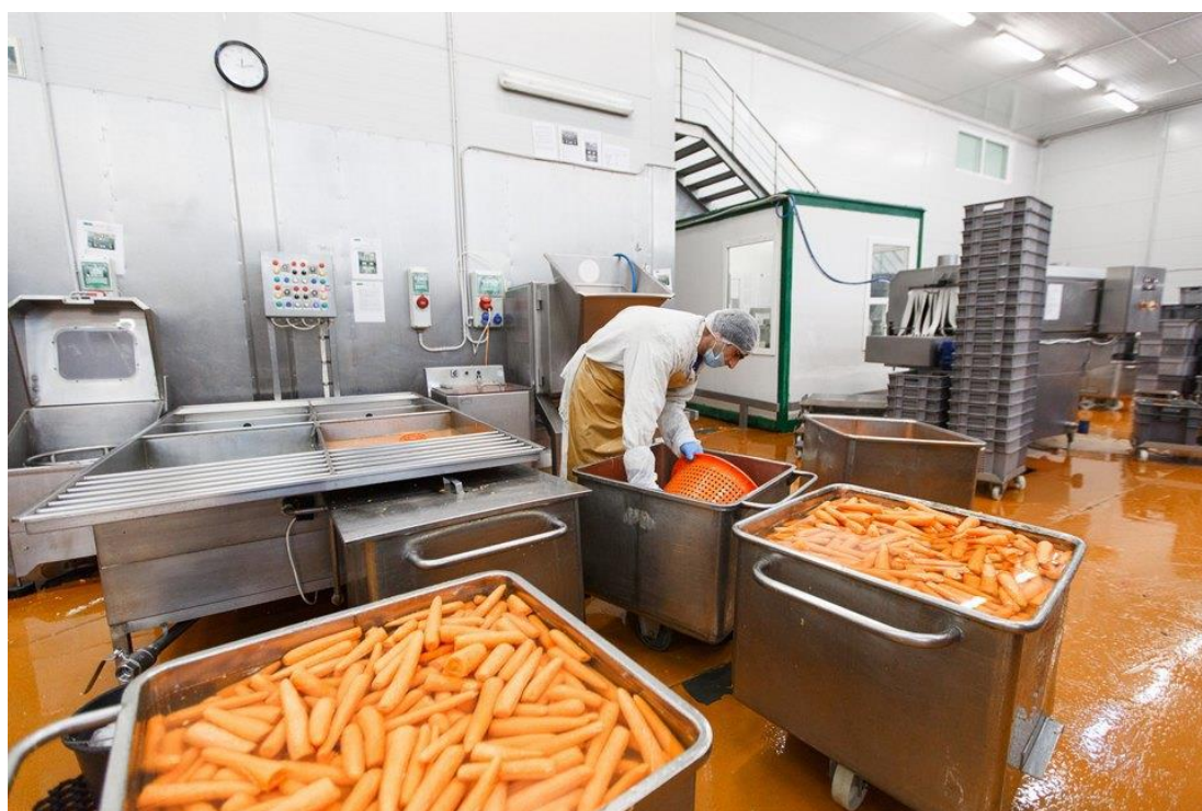
Рис. 2.11. Механическая и гидромеханическая очистка сырья
